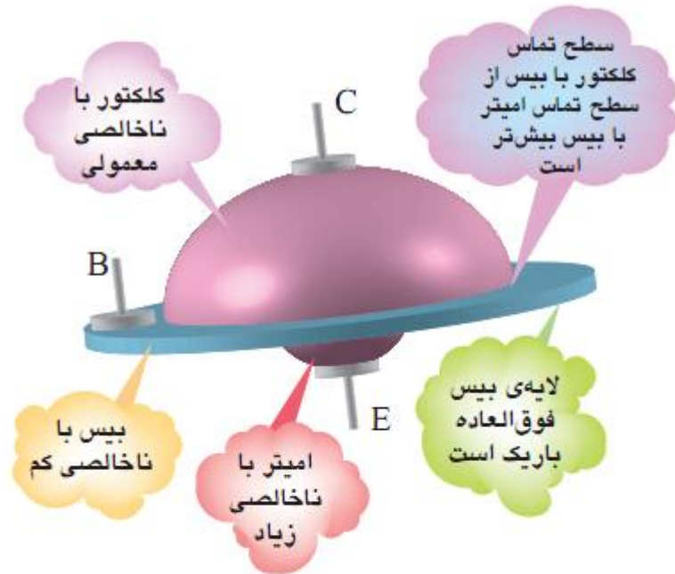
شکل ۵-۵ نمایش نسبت تقریبی لایه‌های ترانزیستور
