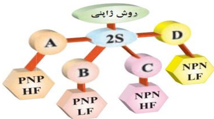
شکل ۸۶-۵ نام‌گذاری ترانزیستورها به روش ژاپنی
