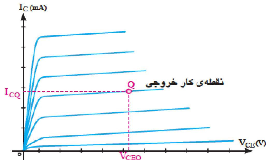
شکل ۵-۳۹ نقطه‌ی کار خروجی روی منحنی مشخصه‌ی خروجی
